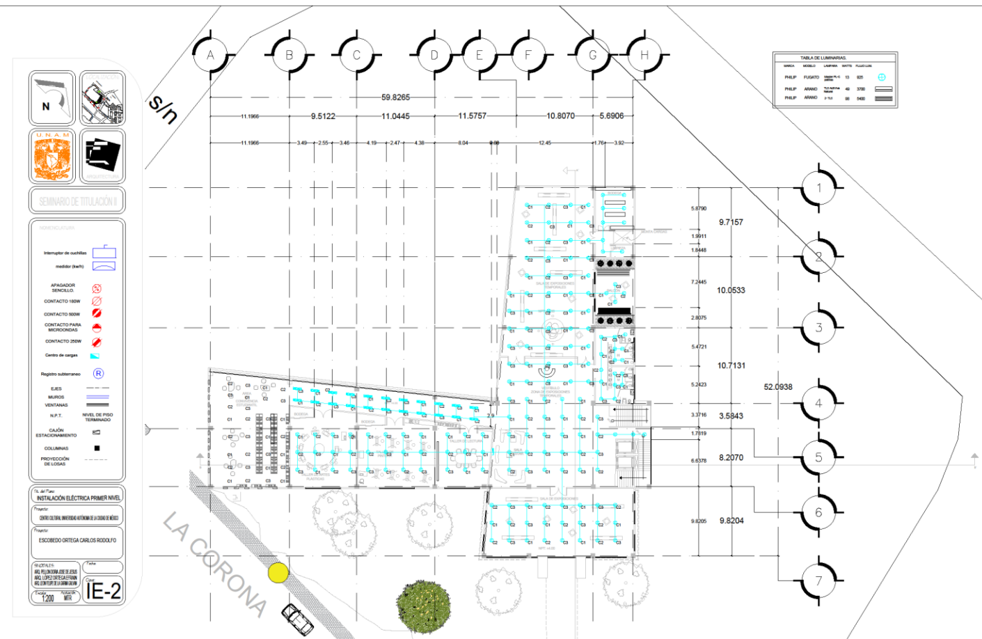
Imagen 97. Primer nivel de instalación eléctrica del Centro cultural UACM plantel Cuatepec. Creación propia.
