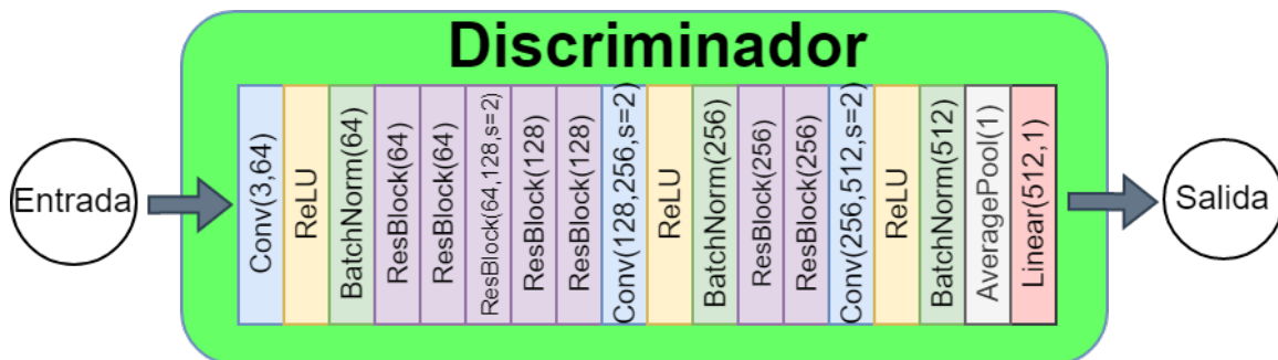
Figura 5.12: Diagrama del discriminador propuesto.
