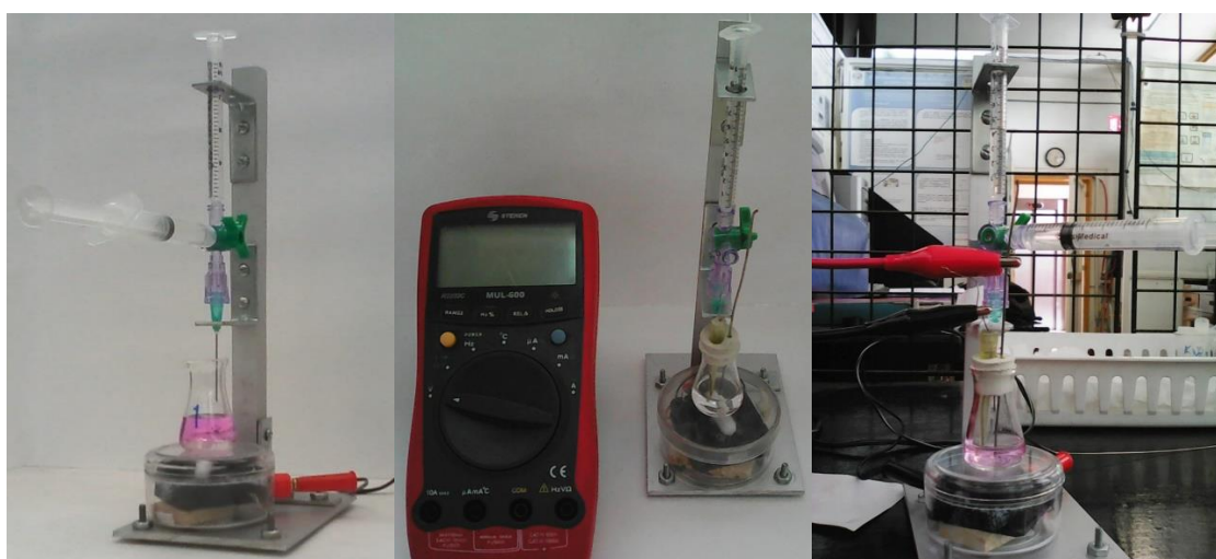
Figura 11. Izquierda: microbureta en soporte de aluminio con agitador magnético y matraz Erlenmeyer. En medio: Multímetro MUL-600, microbureta en soporte de aluminio con matraz Erlenmeyer; ET, ER y agitador magnético. Derecha: Equipo de titulación volumétrica conectado al multímetro.
