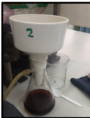
Figura 26. Filtración con succión de vacío para determinación de fibra cruda
