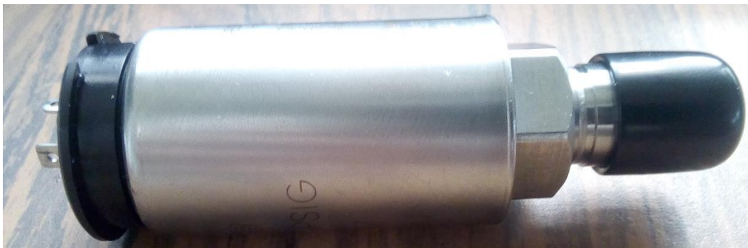
Figura 13. Sensor transductor de presión (PCB Piezotronics inc.), utilizado para la medición de los voltajes asociados a la presión ejercida por el flujo. (elaboración propia)
