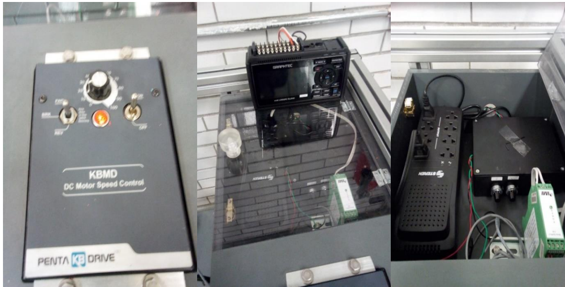
Figura 12. Componentes de la zona de control electrónico. De izquierda a derecha: a) Control de motor, b) Equipo de captura de datos y c) Compensador de voltaje (elaboración propia)
