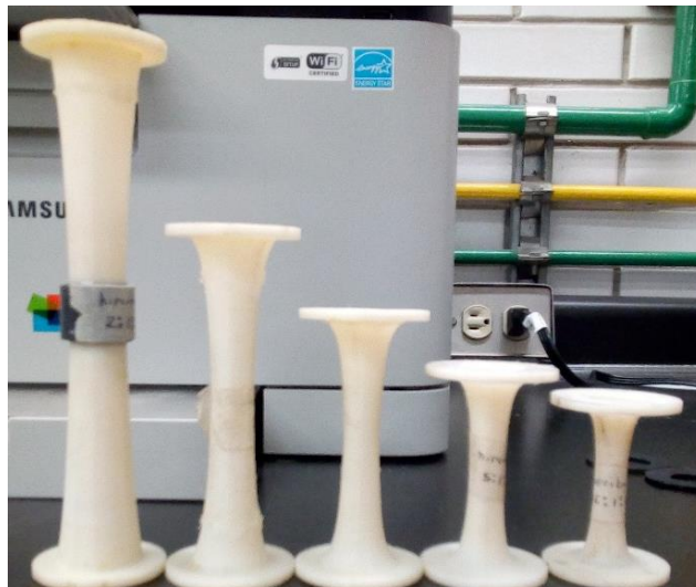
Figura 7. Contracciones modeladas a distintas relaciones de contracción (de izquierda a derecha; 2:1:2, 3:1:3, 4:1:4, 5:1:5 y 6:1:6) (elaboración propia)
