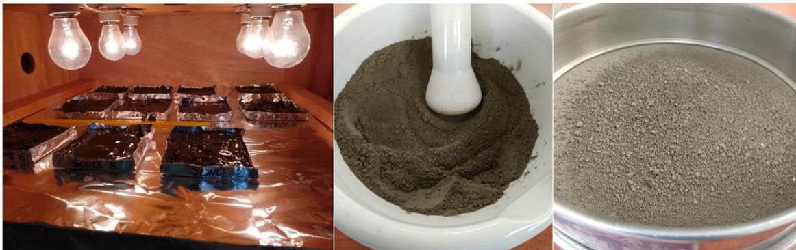
**Figura 10. Proceso de secado (imagen izquierda), molienda (imagen central) y tamizado (imagen derecha).**
