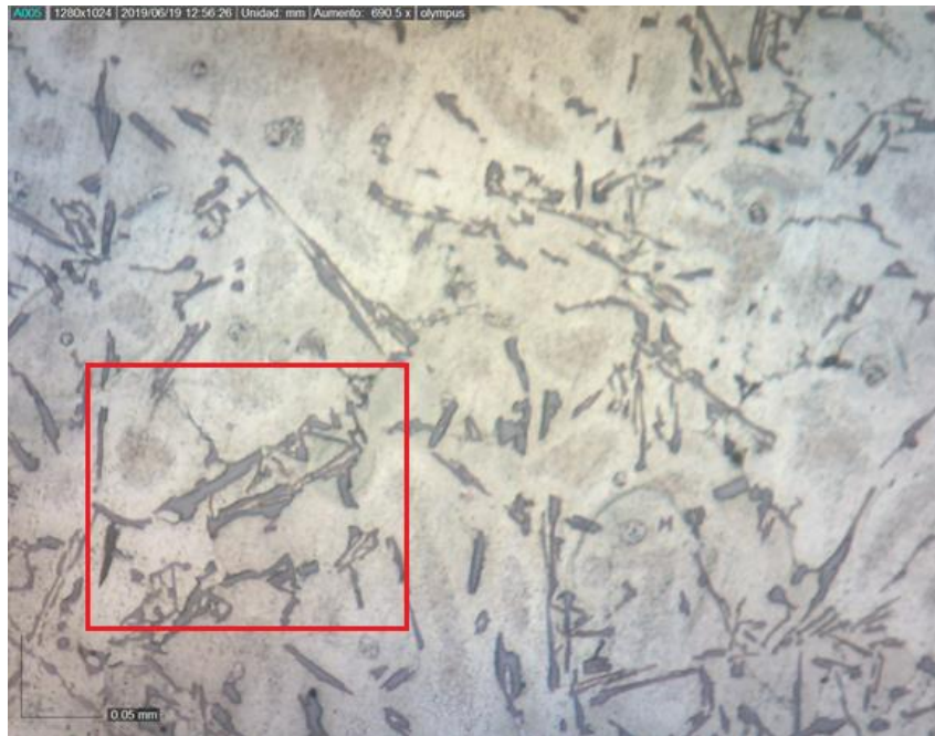
Figura 6.1. Microestructura del material base (corte longitudinal).
