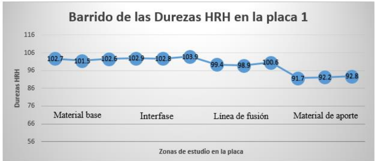
Gráfico 6.9. Barrido de las durezas en escala HRH en las diferentes zonas de estudio en la placa 1 con temperatura de precalentamiento de 100°C y amperaje de 185A.
