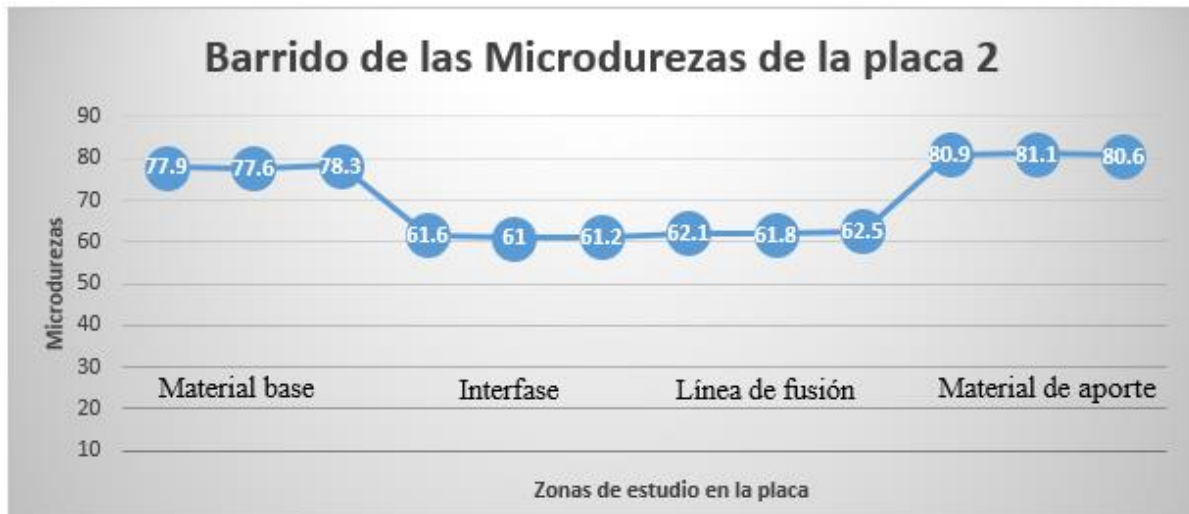
Gráfico 6.13. Barrido de las microdurezas en las diferentes zonas de estudio en la placa 2 con temperatura de precalentamiento de 110°C y amperaje de 190 A.
