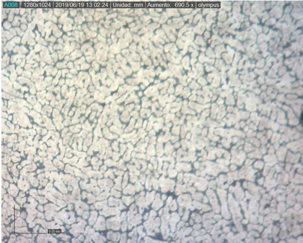
Figura 6.5. Microestructura del material de aporte (corte longitudinal)
