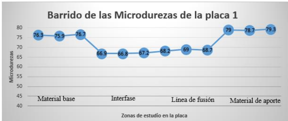
Gráfico 6.12. Barrido de las microdurezas en las diferentes zonas de estudio en la placa 1 temperatura de precalentamiento de 100°C y amperaje de 185A.
