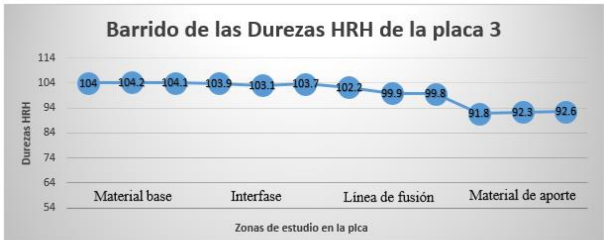
Gráfico 6.11. Barrido de las durezas en escala HRH en las diferentes zonas de estudio en la placa 3 con temperatura de precalentamiento de 120°C y amperaje de 180A.
