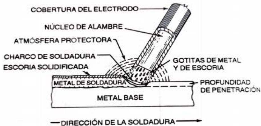
Figura 2.1 Esquema del circuito de soldadura SMAW [1].
