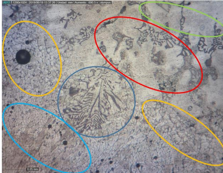
Figura 6.4. Microestructura del material entre las zonas de material de aporte – línea de fusión –zona ZAC - material de base
