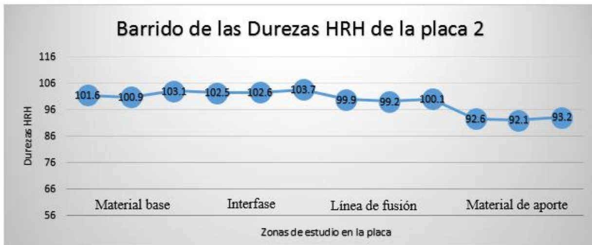
Gráfico 6.10. Barrido de las durezas en escala HRH en las diferentes zonas de estudio en la placa 2 con temperatura de precalentamiento de 110°C y amperaje de 190A.
