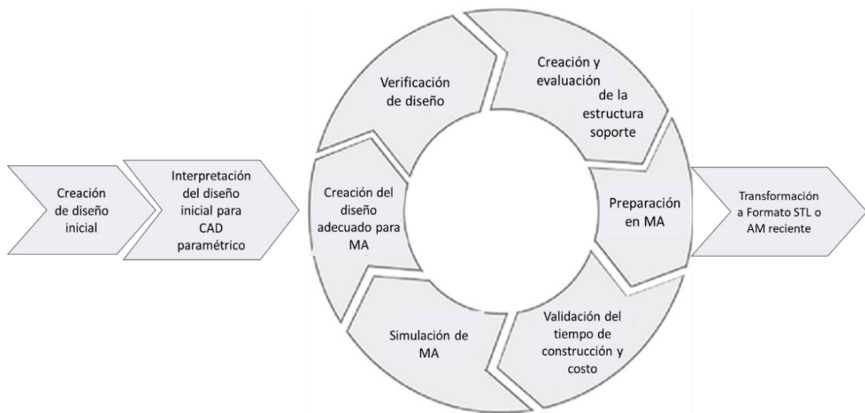
Figura 3.5 Pasos fundamentales a desarrollar en el proceso de diseño (Wiberg, Persson, & Olvander, 2019).
