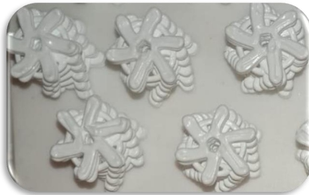
Figura 5.13 Diferentes muestras de piezas manufacturadas de \text{TiO}_2 a diferentes tiempos de manufactura.
