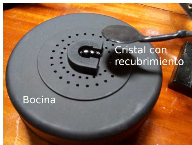
Figura 3.9: Configuración de toma de grabaciones de repuesta a una señal chirp con una bocina Bluetooth.
