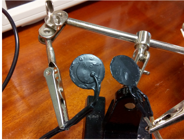
Figura 3.7: Hidrófonos de tercera versión con recubrimiento de goma aislante.
