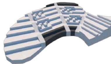
Se plantea un estacionamiento para 20 automóviles y dos estacionamientos de bicicletas estos se ubican en la zona centro del terreno para que conecte con las vialidades principales y secundarias dentro y fuera del terreno, además de que permitirá el transporte y acceso a las diferentes áreas del conjunto habitacional.
