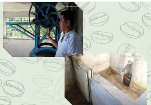
Se utiliza una máquina despulpadora para separar el grano de la pulpa (cáscara de café), el grano pasa a unos tanques de fermentación, cada fruto contiene dos granos de café. Se deja reposar durante 24 horas para que el recubrimiento de miel se separe del grano, luego se lava y se escurre.
