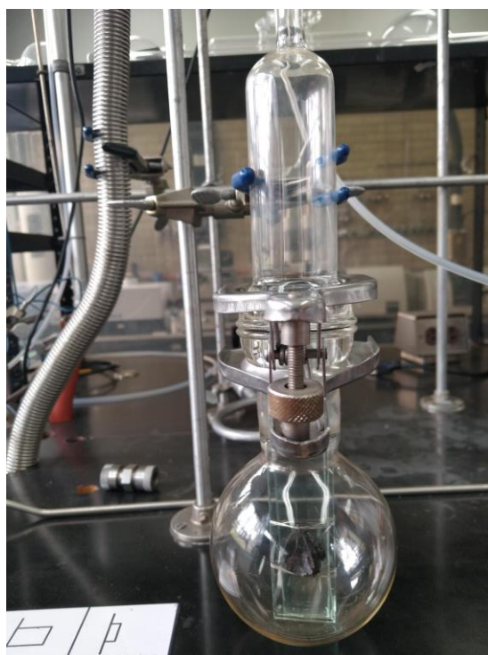
Figura 22. Reactor conectado a la línea de vacío para su llenado. Se logra observar el basalto sujetado a la placa de vidrio.
