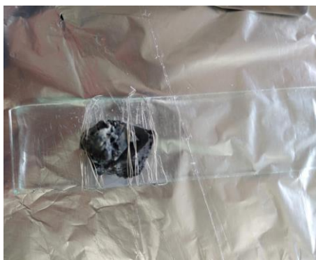
Figura 25. El basalto se amarró con un alambre de aleación de nicromo (Hal-Nicr 80) a un vidrio. Posteriormente se introdujo al reactor para su ablación láser.
