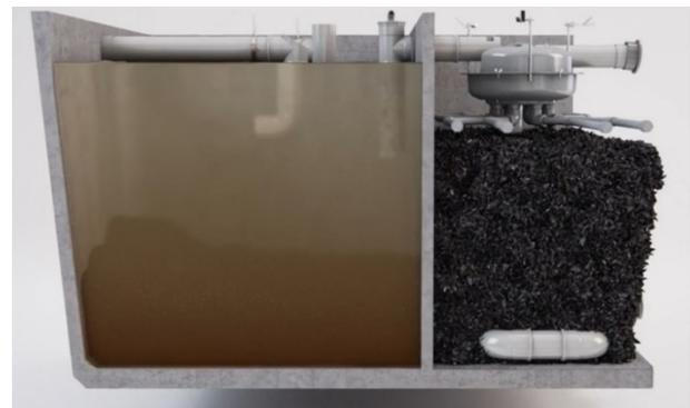
Ilustración 72 Sistema x-perco. Fuente: adaptado de (Eloywater, 2021)
