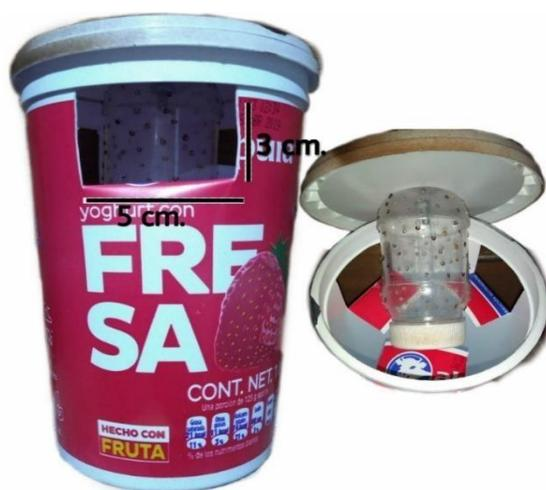
Figura 11. Necrotrampa modificada tipo NTP-80.
