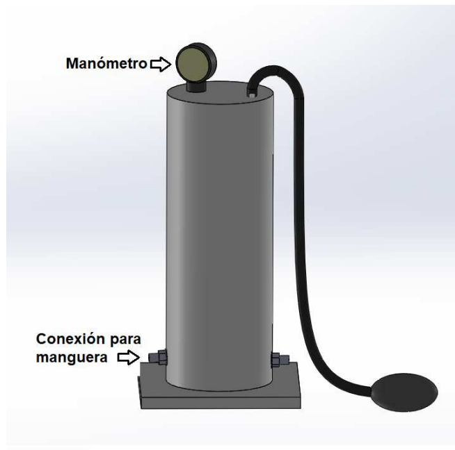
Figura 3.4: Diseño de la cámara de complianza.
