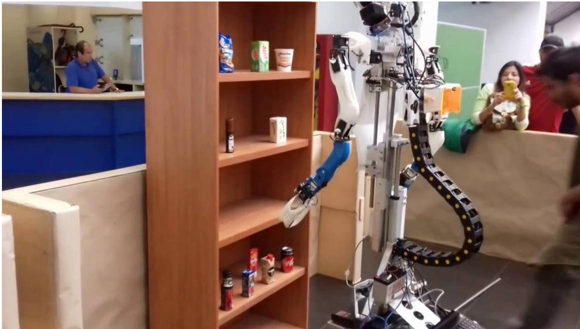
Figura 6.1: Robot Golem III realizando un proceso de estimación de pose que posteriormente le permitirá hacer manipulación robótica.
