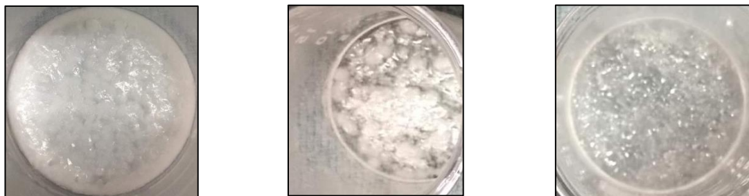
Figura 49. Disolventes eutécticos profundos a partir de mentol y ácido sebácico en una relación molar de 1:1, 1:2 y 3:1 de izquierda a derecha respectivamente.
