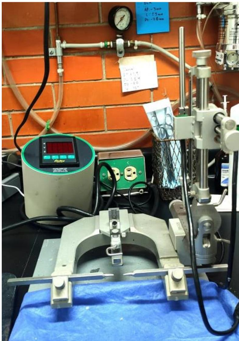
*Nota.* Marco estereotáxico provisto con dos barreras de acero inoxidable y una barra incisora para la introducción de la cabeza de la rata, mediante el cual se realizaron cirugías estereotáxicas para la implantación de cánulas guías.
