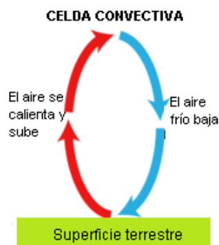
Figura 2.2: Representación de una celda convectiva generada durante el transporte de calor por convección en la atmósfera (Zavadska, 2016).
