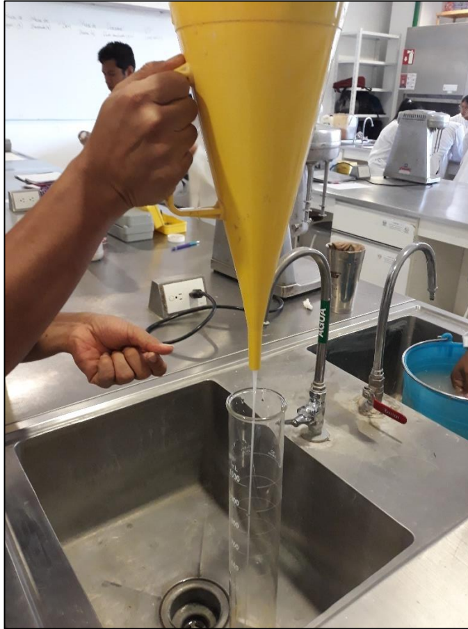
Figura 4. 6 Medición de la viscosidad cinemática Marsh
