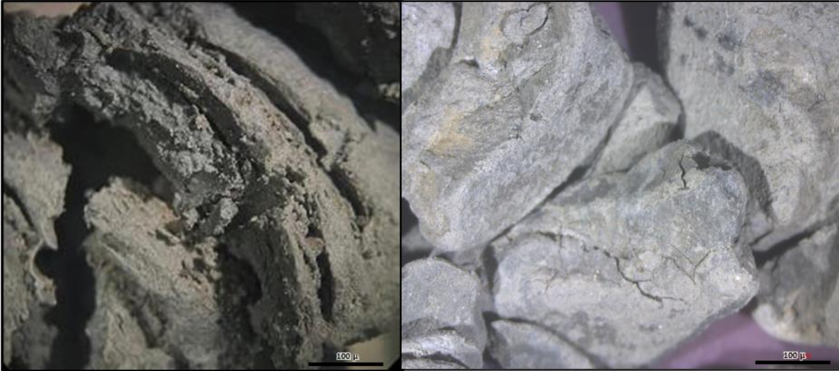
Figura VI.4.9.1. Vista bajo el microscopio estereoscópico de muestras de roca característica de la edad Oligoceno, en la porción Norte de la Cuenca Petrolera del Sureste. Estas rocas se describen como lutita gris claro y gris verdoso, ligeramente calcáreas de aspecto bentonítico.
