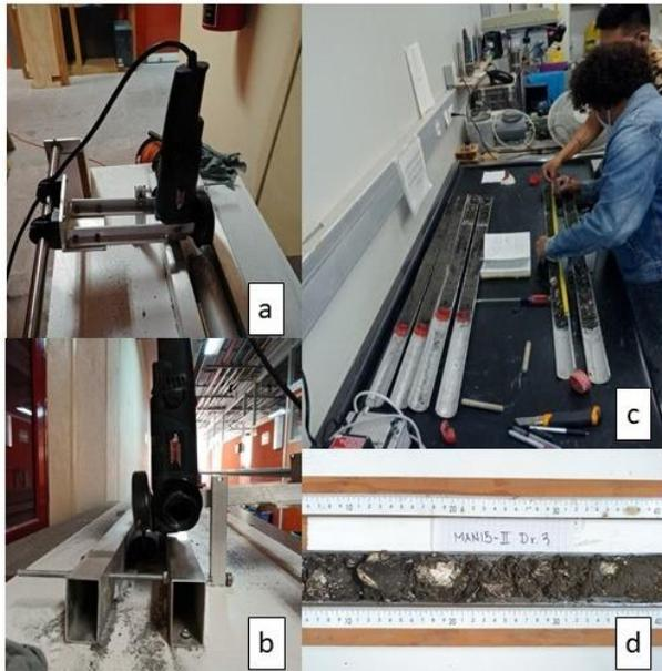
Figura 6. Proceso de abertura de núcleos. a) Cortadora de aluminio. b) cortadora seccionando por la mitad los tubos casing con sedimentos. c) medición y rotulación de los núcleos. d) Fotografiado y descripción de los núcleos.
