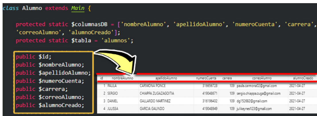
Figura 47: Representación del modelo en PHP y su inherencia con la base de datos. Los atributos del modelo/clase son las columnas de la tabla en la base de datos.
