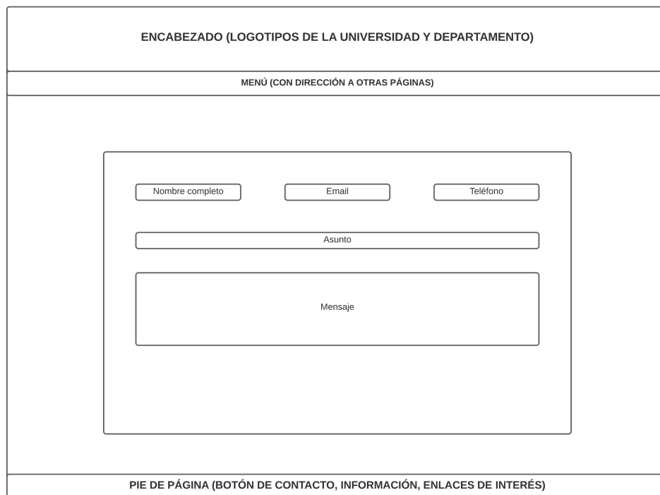
Figura 11: Estructura del documento HTML para el formulario de contacto.
