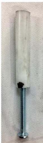
**Figura 11.** Electrodo EPC con una relación 80:20 m:m de grafito y aceite de parafina, empacado en un tubo de teflón, usando un tornillo de acero inoxidable para la extrusión de la pasta y el contacto eléctrico.
