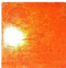
**Figura 14. Transiluminador o filtro de luz casero.** Este fue elaborado por medio de cubreobjetos pintado de color naranja con un sharpin (plumón) para la absorción de luz azul que emita el foco LED UV, este cubreobjetos marcado de color naranja estará en la parte interior de la caja en una distancia de 1.0 cm al sensor de luz.
