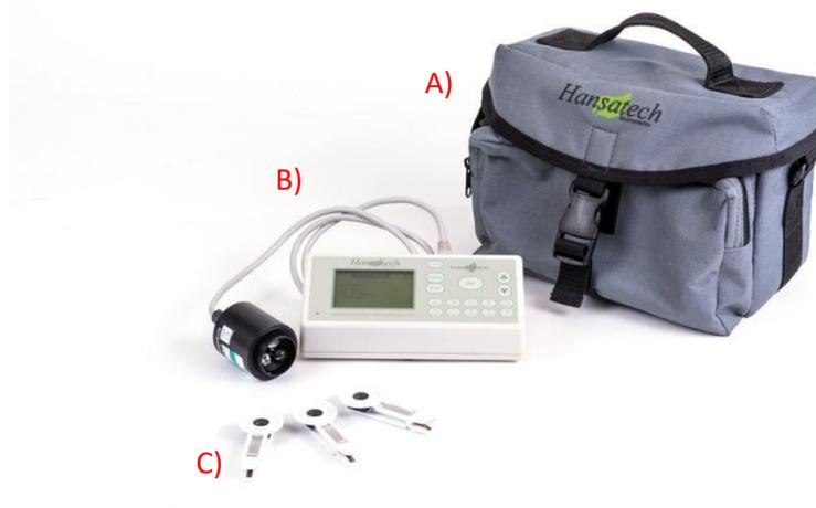
**Figura 2. Fluorómetro de clorofila de excitación continua avanzada portátil, modelo Handy PEA+, de la empresa, Hansatech-instrument.** El equipo contiene: A) Estuche portátil, donde se guarda el instrumento y accesorios para recolectar resultados en el campo, B) La unidad del sensor compacto y de teclado táctil con su matriz de 3 LED rojos ultrabrillantes C) Leafclip de hojas de adaptación a la oscuridad para mantener a las hojas en un estado de relajación.
