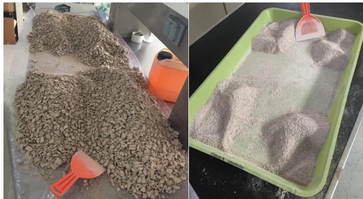
Figura 15. Homogeneización y cuarteo de roca caliza de llegada (Izquierdo) y en malla 10 (Derecha)
