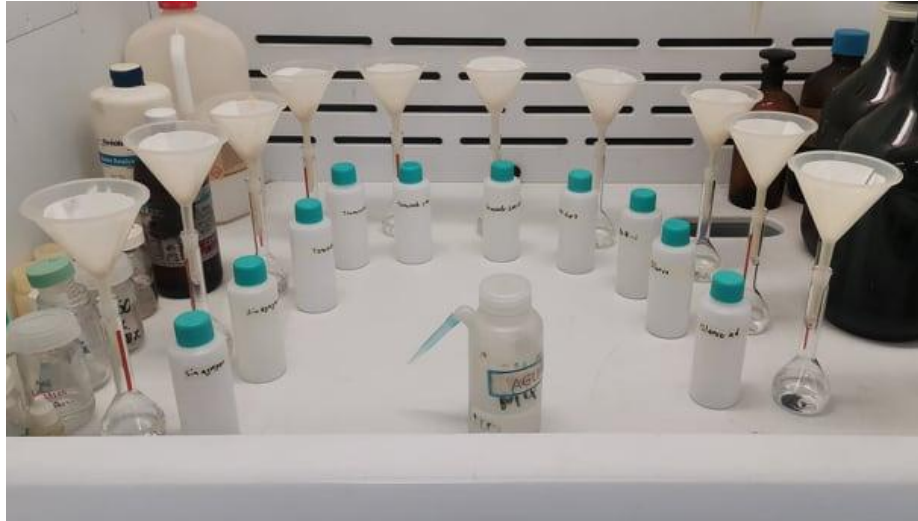
Figura 19. Filtrado y aforo de las muestras después de la digestión por microondas.
