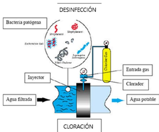
**Figura 6:** Cloración: Las aguas residuales son expuestas a una concentración definida del desinfectante, durante un tiempo de contacto controlado para poder eliminar los microorganismos patógenos que se encuentran dispersos (El agua potable, s.f.).
