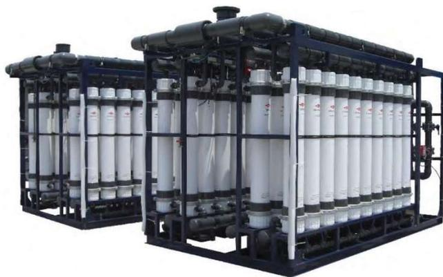
**Figura 5:** Ultrafiltración con membrana tubular: La ultrafiltración es un proceso de filtración de membrana que busca eliminar sólidos suspendidos, bacterias, virus, etcetera con la finalidad de producir agua con muy baja cantidad de sedimentos. Las membranas tubulares se usan para aplicaciones de agua residual para líquidos viscosos o de muy mala calidad (ECOPRENEUR, 2017).
