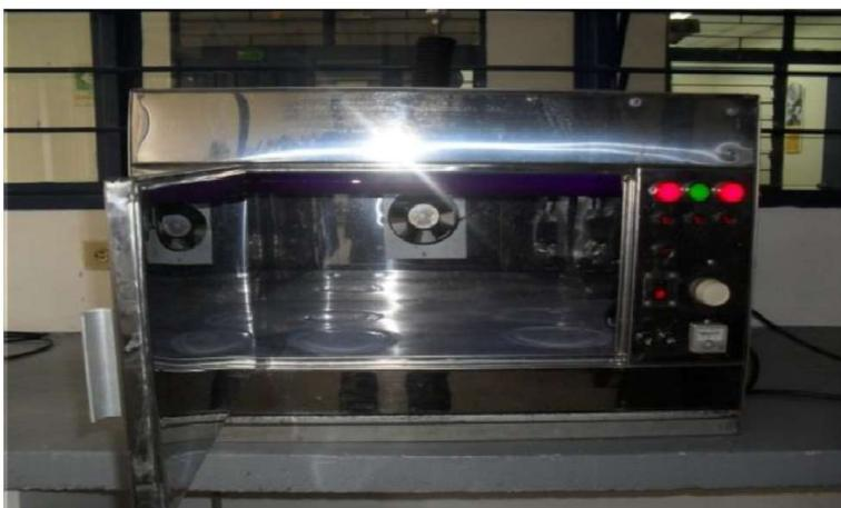
**Figura 41.** Reactor fotocatalítico tipo batch de tres lámparas de 15 W (Valencia Sanchez, Reinoso Osorio, & Arias Ramírez, 2012).
