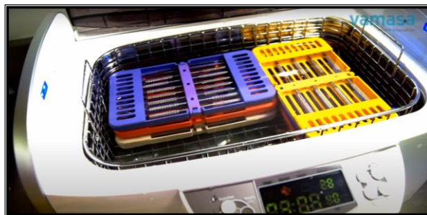
Figura 3.11 y 3.12 Colocación del instrumental en la máquina de lavado ultrasónico. 15 16
