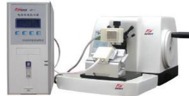
Figura 3. Micrótopo de Congelación (tomada de KD-3358-III "KEDEE").
