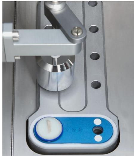
Figura 21. Plataforma de congelación y en azul se muestra la unidad Peltier.
