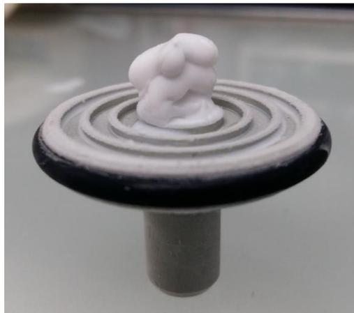
Figura 20. Montaje y orientación de la muestra en gel tissue-tek (OCT) sobre la platina porta muestras.
