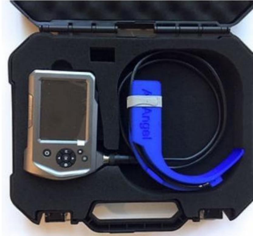
**Figura 5.** Boroscopio a emplear junto acomplado a un laringoscopio AirAngel.
