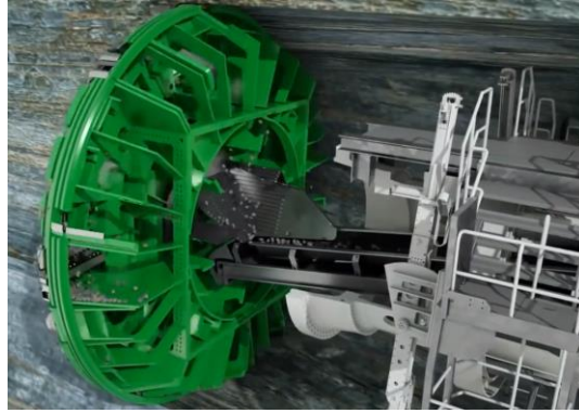
Figura 2.21 Sistema de extracción de rezaga (Herrenknecht, 2019).
