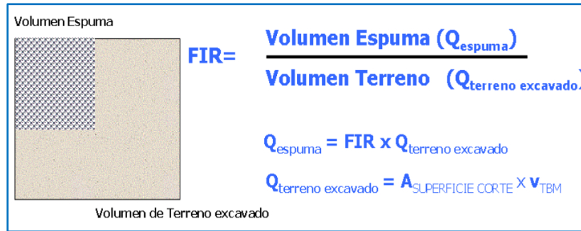
Figura 2.5 Tasa de inyección FIR (MEYCO, 2008).
