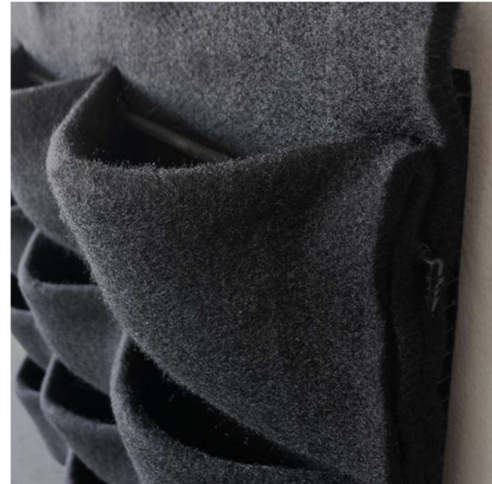
Geotextil muro verde hidropónico Fuente: http://www.hildebrandt.cl/caracteristicas-y-beneficios-de-los-muros-verdes
