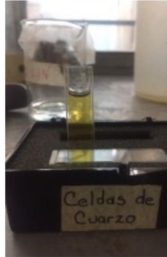
*Figura 23. Celda de cuarzo después de acidificar.*
