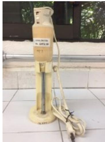
**Figura 21. Homogeneizador de tejidos utilizado para la maceración del filtro.**
