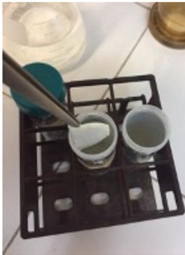
**Figura 20. Colocación de filtro dentro de tubo de centrifuga, previo a su maceración.**
