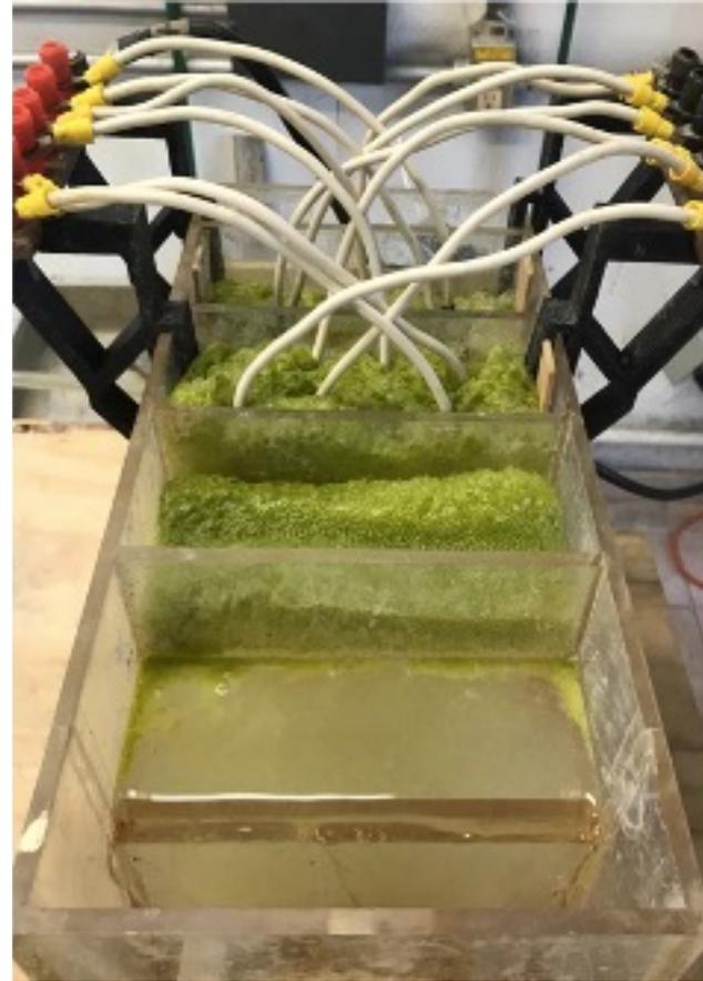
*Figura 58. Acumulación de espuma en una configuración horizontal en operación (vista superior).*
