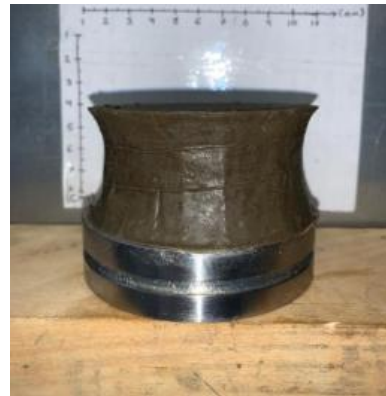
d) TBH-356-V después de consolidar
