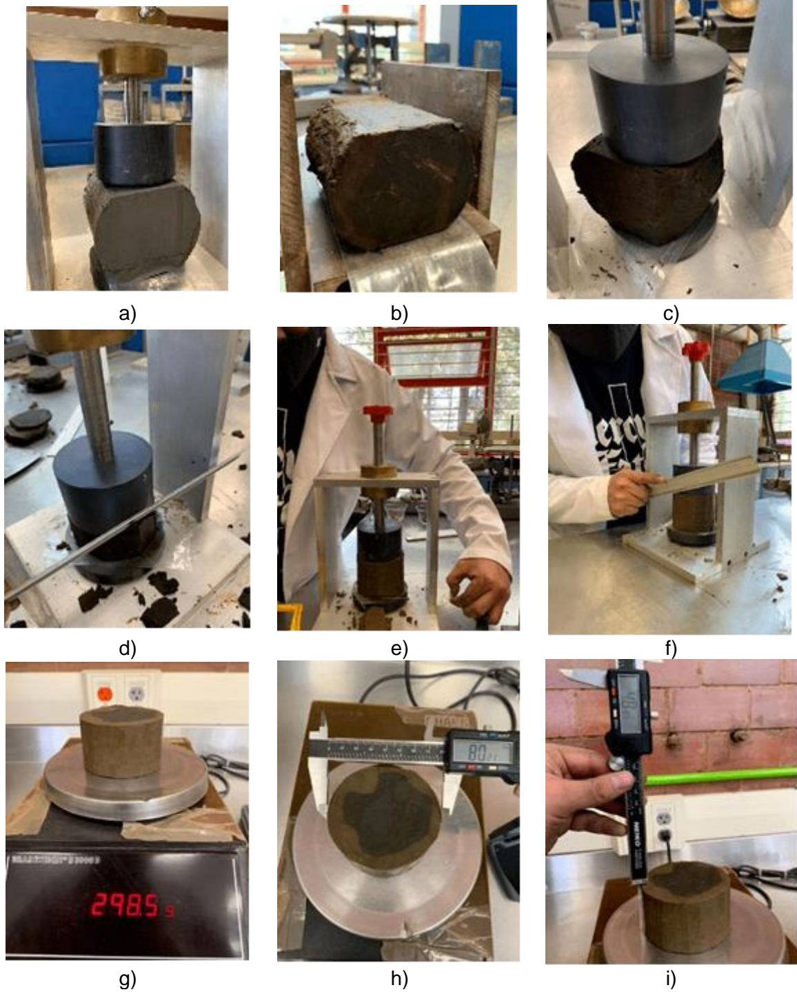
Figura 3.7. Proceso para el labrado transversal de las muestras de suelo fino.
