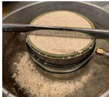
c) emparejamiento de arena con pisón d) enrazamiento de arena en el molde
