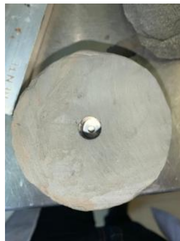
b) verticalidad del orificio central
