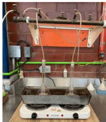
b) matraces conectados al sistema de vacío
