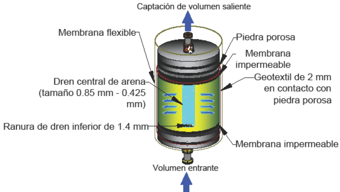
Figura 2.12. Flujo radial en un permeámetro de pared flexible
