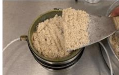
b) medición y llenado del molde con arena
