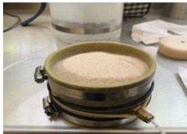
b) medición y llenado del molde con arena
