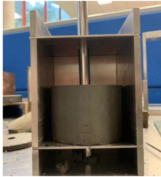
b) muestra de suelo debidamente atravesada
