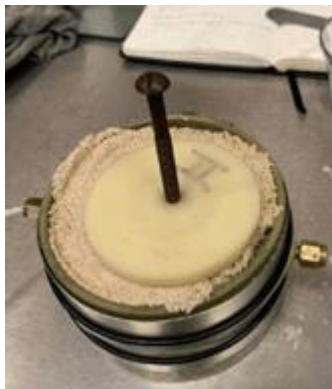
c) emparejamiento de arena con pisón d) enrazamiento de arena en el molde
