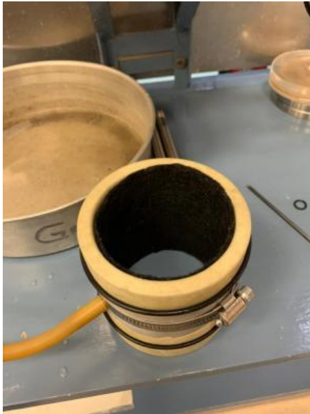
a) molde de vacío con geotextil
