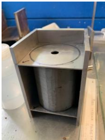
a) centrado de muestra en el soporte metálico con las placas guía
