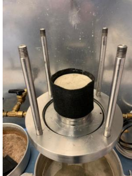
b) geotextil colocado en la probeta
