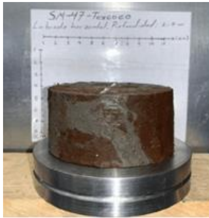
a) SM-47-H antes de consolidar
