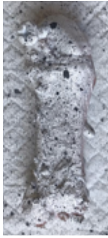
Figura 8. Patrón moteado realizado a partir de la colocación de una base de pintura en aerosol blanca sobre la cual se realizó un moteado con pintura en aerosol negra para la realización del estudio interferométrico por correlación de imagen.
