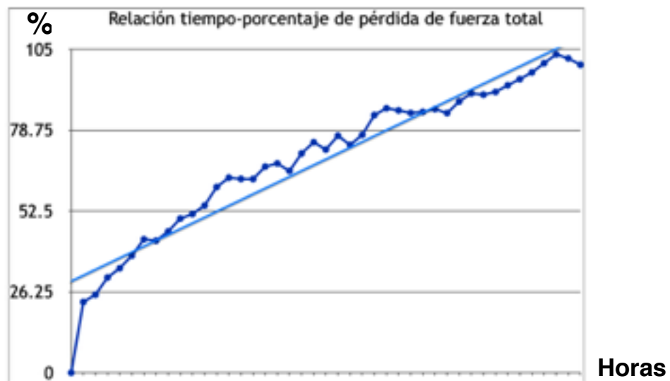
Gráfica 3. Relación de la pérdida de fuerza total en la que se aprecia un incremento súbito inicial seguido por una pérdida casi lineal de la misma.
