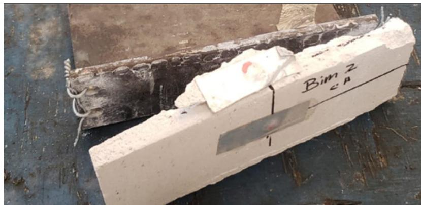
Figura B.5. Estado de la probeta tras cortar con la segueta bimetal 2.
