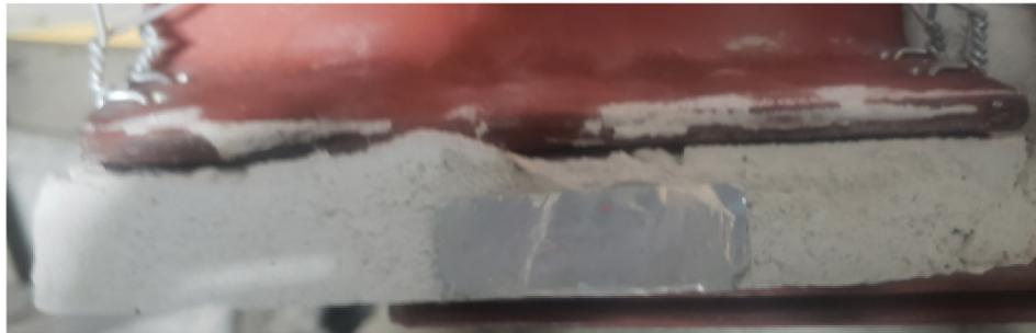
Figura B.3. Estado de la probeta tras cortar con la segueta bimetal 1.
