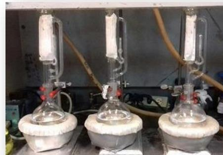
**Figura 6.** Extracción continua, usando el equipo Soxhlet.
