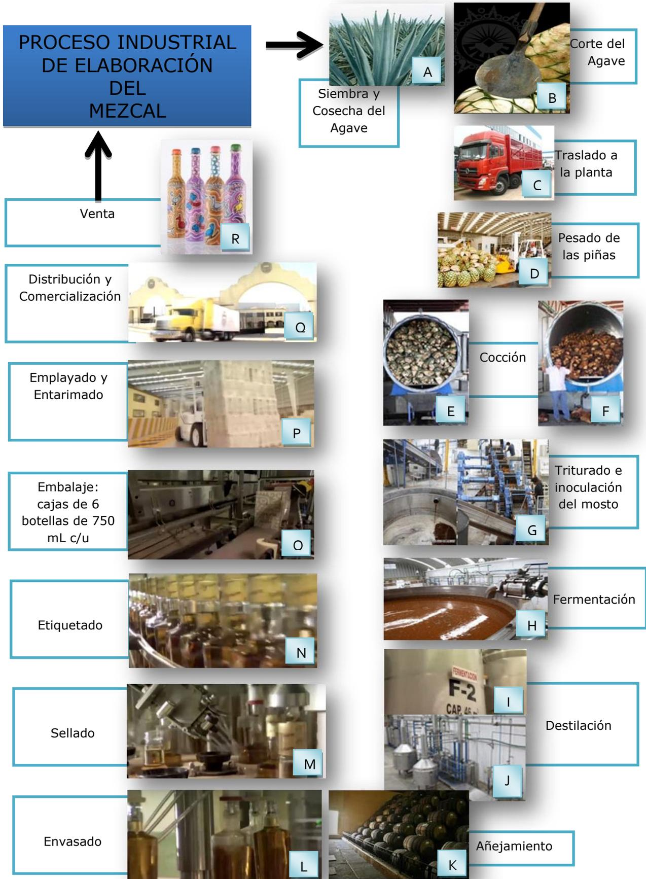
Figura 4.4.N. Proceso industrial de elaboración del mezcal
