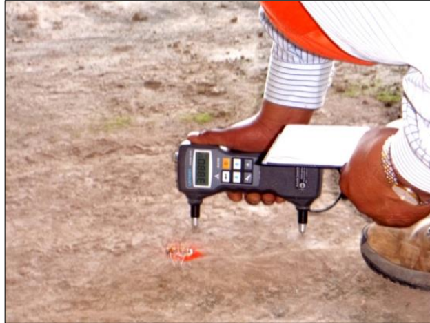
Figura 31. Equipo empleado en la medición de las velocidades de onda P con ultrasonido. Fuente: (Sergben, Ingeniería del Subsuelo S. A. de C. V., 2013).
