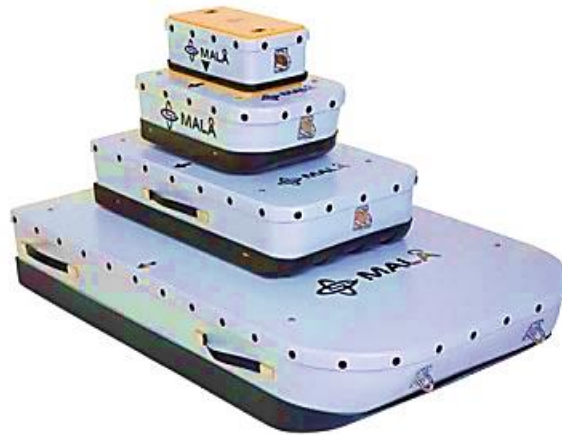
Figura 9. Antenas blindadas de 100, 250, 500 y 800 MHz de la marca MALA. Fuente: (Geoelec, 2017)
