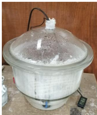
Figura 2. 5. Desecador que permite tener una atmósfera controlada para ensayo de corrosión acelerada.
