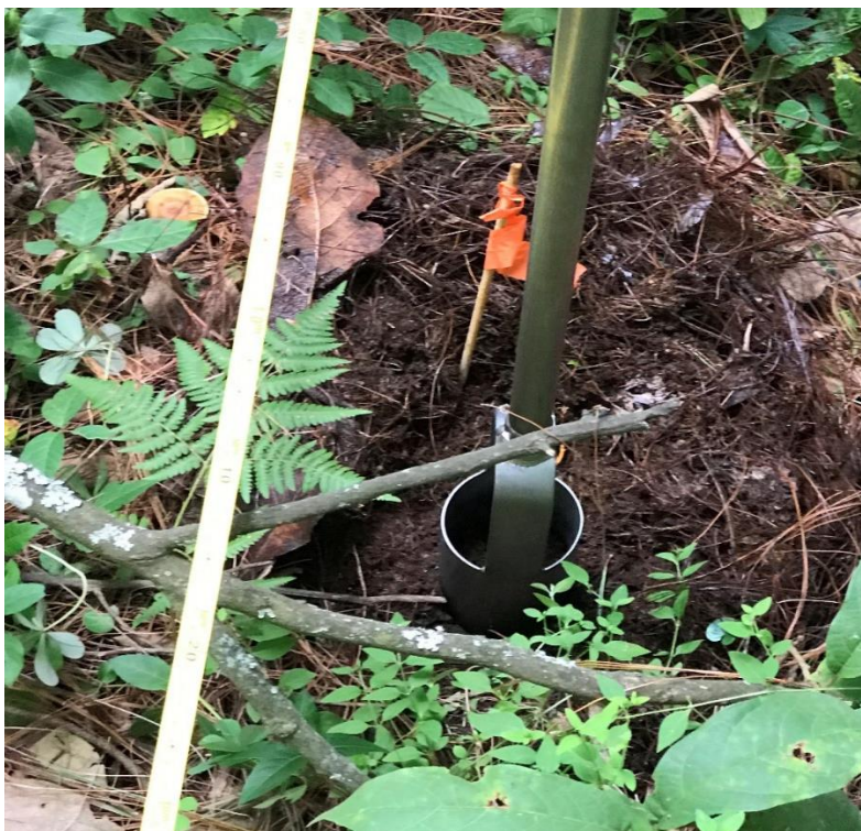
Imagen 6. Colecta de muestras de suelo con un nucleador.
