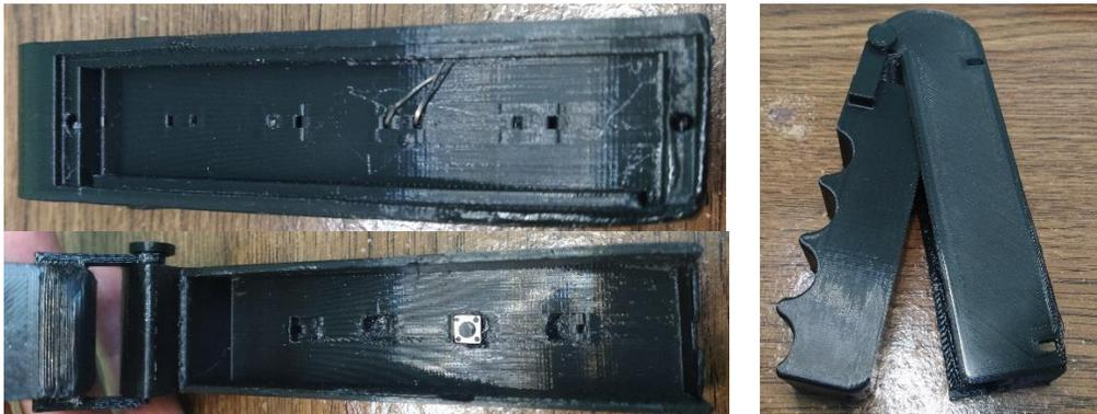
*Ilustración 4.11 Prototipo descartado del módulo para activación por agarre de mano.*
