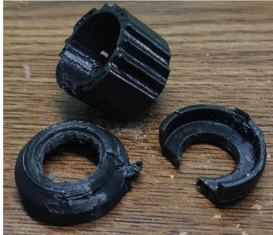
*Ilustración 4.7 Piezas defectuosas variante 1 módulo de activación por pulgar.*
