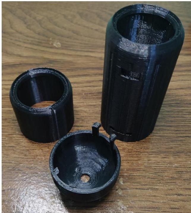
*Ilustración 4.8 Piezas defectuosas de la variante 2 del módulo de activación por dedo pulgar.*
