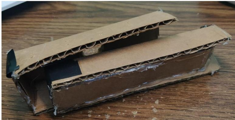
*Ilustración 4.9 Prototipo de cartón del módulo agarre de mano.*
