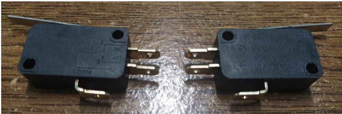
*Ilustración 3.28 Interruptores parecidos al del módulo gatillo.*
