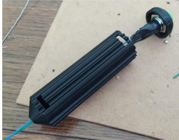
*Ilustración 3.15 Preensamblado del botón pulgar.*
