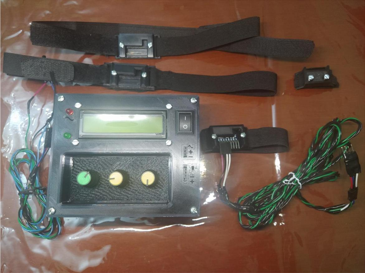
*Ilustración 3.65 Módulo con acelerómetro.*
