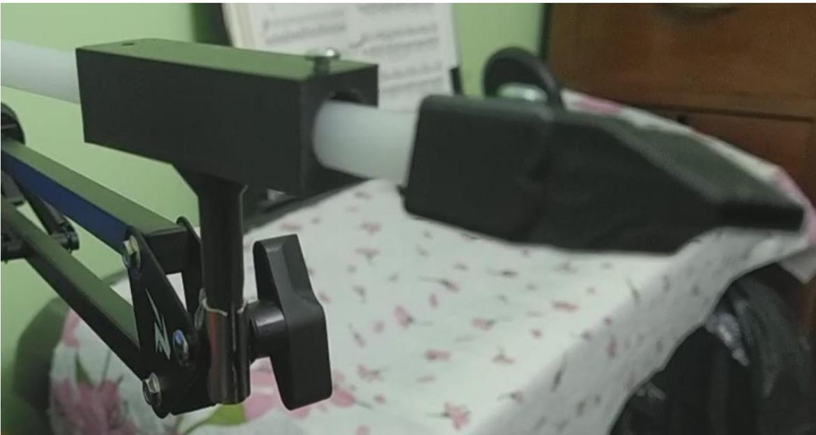
*Ilustración 3.46 Boquilla con soporte.*
