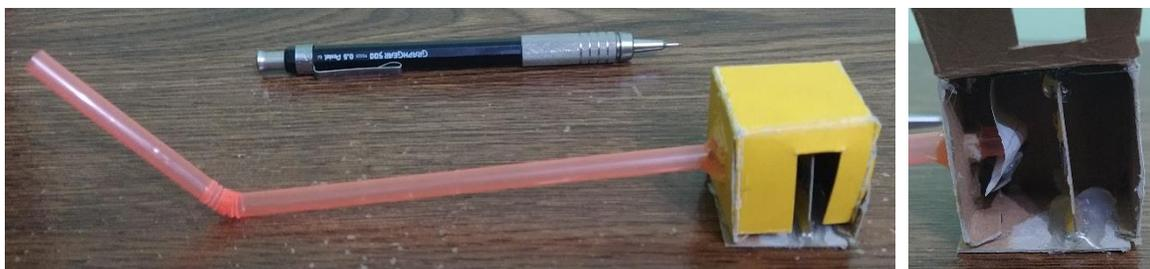
*Ilustración 4.16 Prototipo 1 en cartón del módulo de activación por soplido.*
