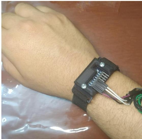
*Ilustración 4.40 Ejemplo de colocación del acelerómetro.*
