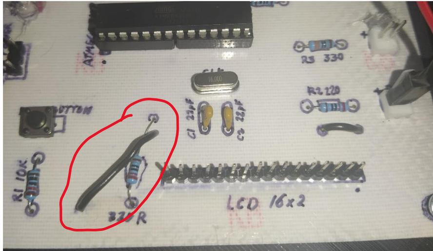
*Ilustración 4.33 Puente en el PCB del módulo con acelerómetro.*
