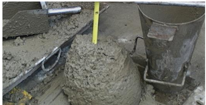
FIG. 51 MUESTREO DE CONCRETO.
