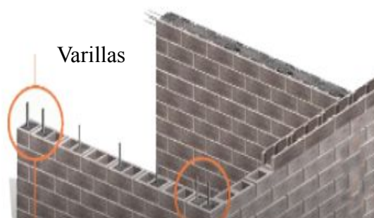
Imagen 206. Ejemplo de colocación de muros en sótano.
