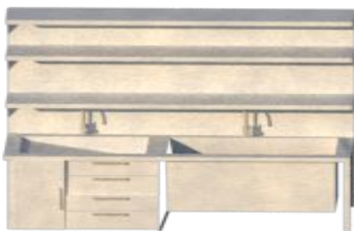
Imagen 235. Alzado frontal de tarja de lavado para piezas arqueológicas.
