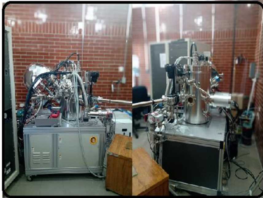
Figura 3.3 VG Microtech ESCA2000 Multilab Sistema UHV. Este equipo se encuentra en el IIM.
