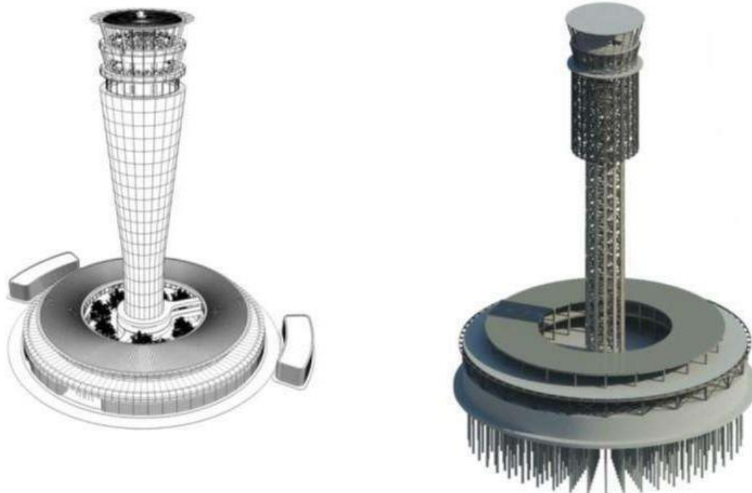
Imagen 53 Vista general de la forma arquitectónica (izq.) y del sistema estructural (der.) de la TCTA, NAICM
