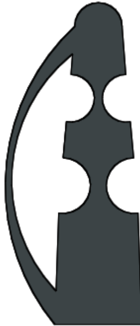
Figura 37. Modelo 1 de dedo índice con muelle.
