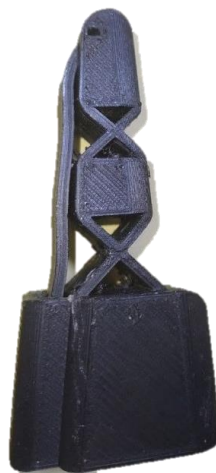
Figura 56. Impresión 3D de dedo índice.
