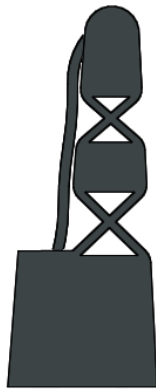
Figura 51. Modelo de dedo con pivote de flexión.
