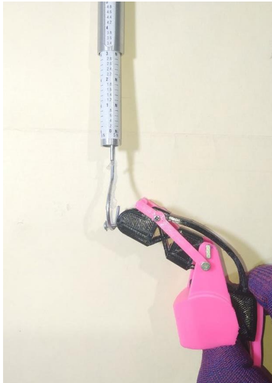
Figura 99. Prototipo de dedo para lectura de dinamómetro.
