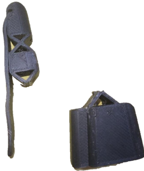
Figura 57. Impresión 3D fracturada.
