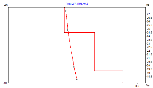
Figura A77: Modelo estimado 1D de velocidad de onda S, correspondiente al disparo 2 de la línea 4.
