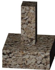
Figura 2.2: Ilustración de zapata.
