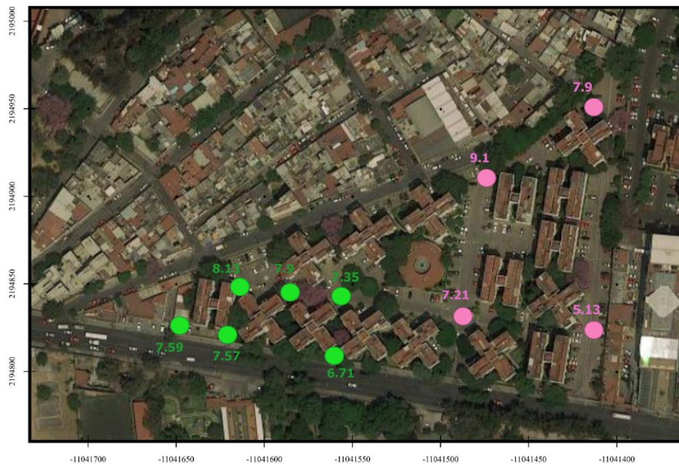
Figura 31: Mapa de frecuencias dominantes obtenidas para todos los puntos de vibración ambiental
