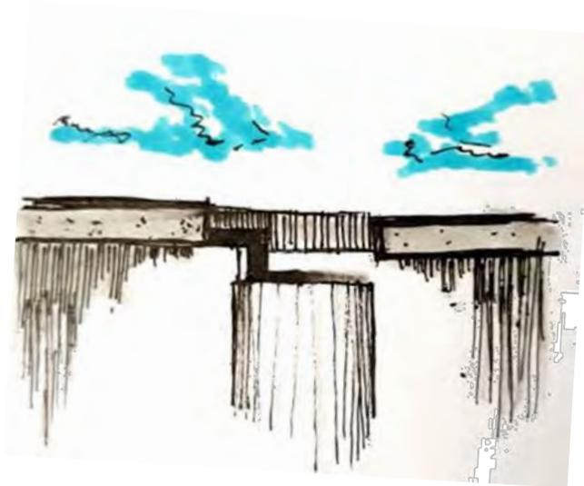
Imagen117. Croquis de detalle de apoyo de losa en columna.
