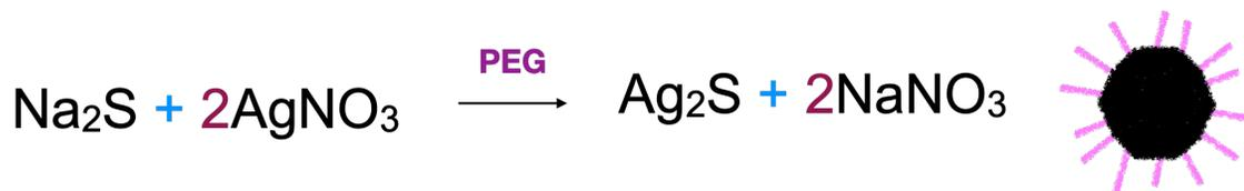
Figura 11 Reacciones en la síntesis experimental del sulfuro de plata (Fuente propia)
