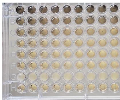
Figura 26. Placas de ensayo de microdilución en donde se puede observar la concordancia de la concentración mínima inhibitoria obtenida en cada muestra de sulfuro de plata a) sulfuro de plata comercial (Ag<sub>2</sub>S COM), b) Sulfuro de plata experimental (Ag<sub>2</sub>S EX) y c) Sulfuro de plata experimental con polietilenglicol (Ag<sub>2</sub>S PEG).
