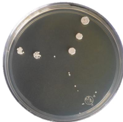
Figura 14 Sembrado de concentraciones para la determinación de la Concentración Mínima Inhibitoria del sulfuro de plata experimental (Fuente propia)
