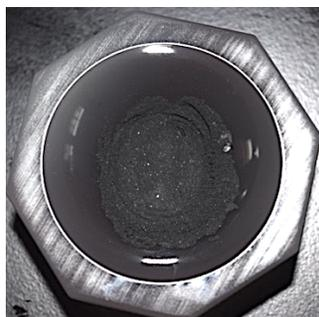
Figura 12 Sulfuro de plata pulverizado en mortero de Agata (Fuente propia)
