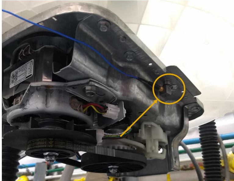
Figura 5.9 Posición de sensor triaxial en sistema impulsor
