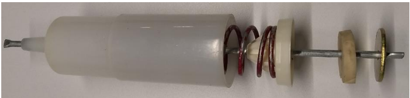
Figura 6.9 Ensamble suspensión incluyendo la arandela de material VEM
