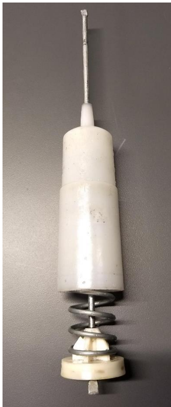
Figura 5.13 Probeta de suspensión para medición en banco de pruebas
